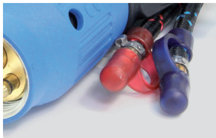
Schutzkappen auf Wasserschläuchen.
