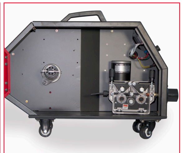
Drahtaufnahme für Spulen bis 15 kg
