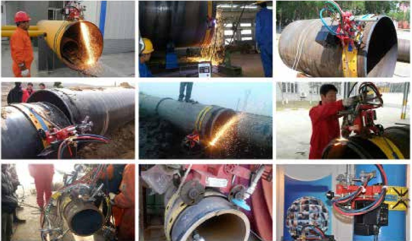
Die Rohrschneidanlage ist sowohl zum Autogen- als auch zum Plasmaschneiden geeignet! Egal ob Stahl, Edelstahl oder sogar Gusseisen, Rohre können mit der JM-ST Rohrschneidanlage ohne weiteres in jeglicher Form, wie z.B Kreise oder Spirale, ausgeschnitten werden.
