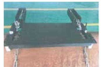
Um den Standfuß auch auf kleinen Rohrdurchmessern optimal zu befestigen kommt der Sattelhalter zum Einsatz.
