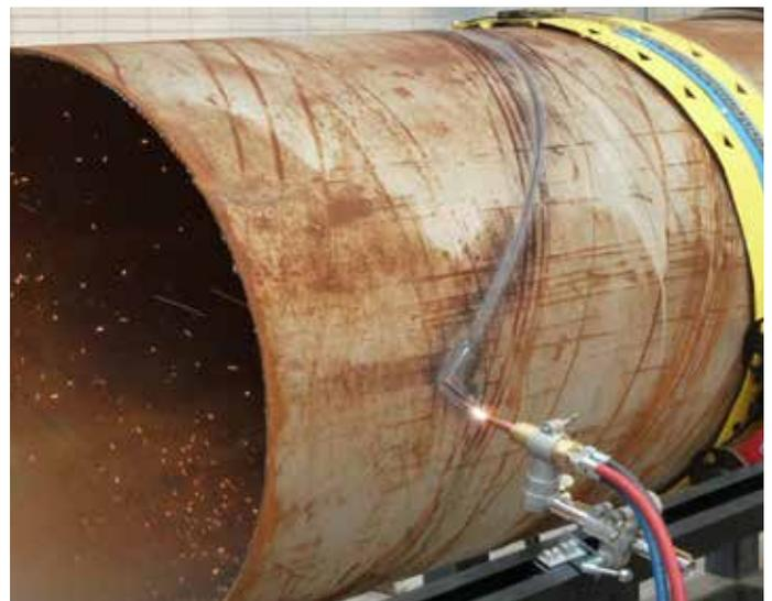
Die Anlagen sind für Plasma- und Autogenschnitte geeignet. Je nach Brenner und Stromquelle können Schnitte zwischen 5 und 80 mm Materialstärke ausgeführt werden.
